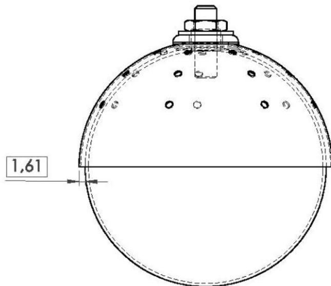
6) Raccorder un fil électrique (phase) (16 A) sur le haut de la tige soudée à la sphère.
