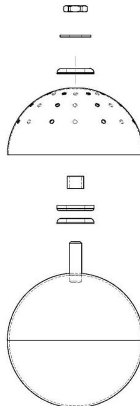
5) Visser un écrou sur la tige et régler l'écartement entre la demi-sphère supérieure et la sphère inférieure pour se rapprocher idéalement d'un écart de 1,61 mm (nombre d'or). Si l'écart est beaucoup moindre (0,6 à 0,9mm) alors il y aura court-circuit. Si l'écart est supérieur à 1,8 - 1,9 mm, alors l'effet ne se produira pas.
