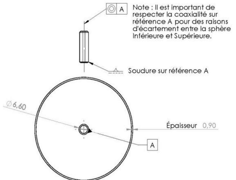
3) Percer la demi-sphère d'un trou central correspondant au diamètre de la tige de la sphère (éventuellement augmentée de l'épaisseur de l'isolant). Percer également une vingtaine de trous au maximum d'un diamètre de 2 mn, pour donner un aspect passoire à la demi-sphère.
