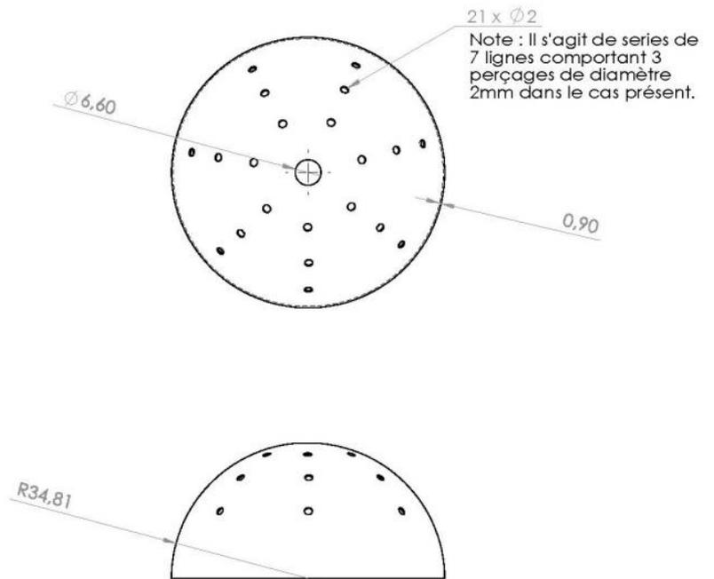
4) Mettre à la base de la tige soudée sur la sphère 2 rondelles plastiques de 2 mm, percer la demi-sphère au centre et ajuster l'écartement à 1,6 1,7 mm environ.
